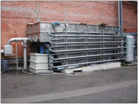
Der Vorgang der Entschlammung bewirkt die Trennung von den Feststoffen und der Flüssigkeit oder Feststoffe aus einer Emulsion. Man benützt deren geringes spezifisches Gewicht oder man injekziert einen Gasstrom und bringt sie an der Oberfläche zum Schwimmen. In beiden Fällen wird das Prinzip des Archimedes, von den Feststoffen in einer
