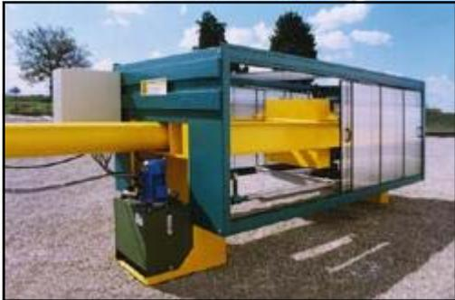
Die Filtertücher werden nach Art des Schlammes ausgewählt. Die Elektroanlage wird nach CEI Norm ausgeführt, mit hochwertigen Materialien und die Schaltung ist elektronisch PLC-gesteuert, für den automatischen Ablauf des Filtervorganges und für die Entleerung und den gesamten Ablauf. Die BESCHICKUNG der Presse wird von einer pneumatischen Membranpumpe oder Zentrifugalpumpe oder Kolbenpumpe ausgeführt.
