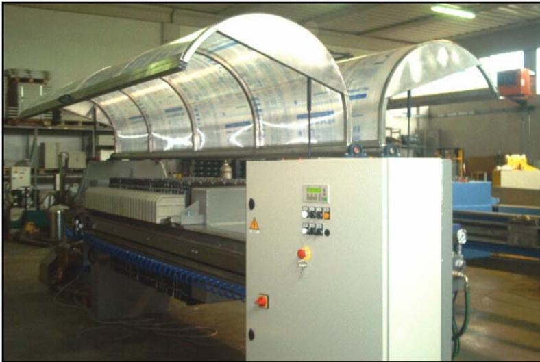
Kammerfilterpresse mit Filtertuch, für die Trennung der Feststoffe von:
