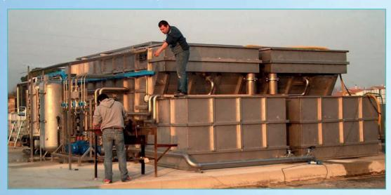
La flottation est l'opération au travers de laquelle les substances solides suspendues, ou bien les substances en émulsion, sont séparées du liquide, ou bien en exploitant la faiblesse de leur poids spécifique, ou bien en provoquant éventuellement leur flottement au travers de l'injection d'un courant gazeux.
